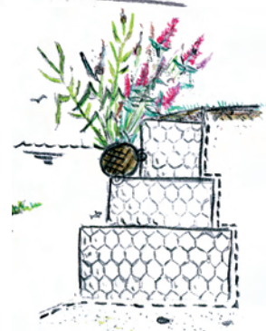
F. "Groene Gracht" Aqua-Flora rollen opgehangen d.m.v. staal draad aan een oever in schanskorven.
