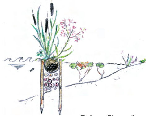
E. Aqua-Flora rollen en rijshoutpalen tussen een dubbele perkoenpalen rij als vòòr-oeverbescherming van een oever in 'groot' water, zoals meren.
