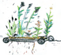
H. Aqua-Flora rollen een dubbele rij Aqua-Flora rollen ter bescherming van een steile oever.
