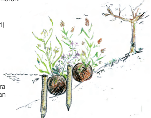
F. "Groene Gracht" Aqua-Flora rollen opgehangen d.m.v. staal draad aan een oever in schanskorven.
