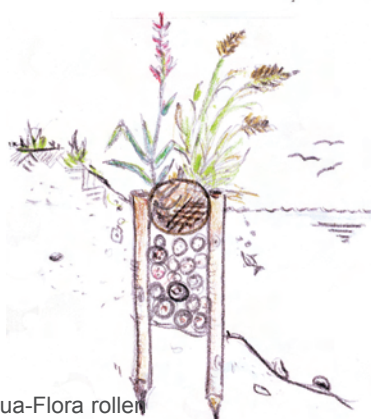
D. Aqua-Flora rollen en rijshoutbossen tussen een dubbele perkoenpalen rij ter bescherming van een steile oever.
